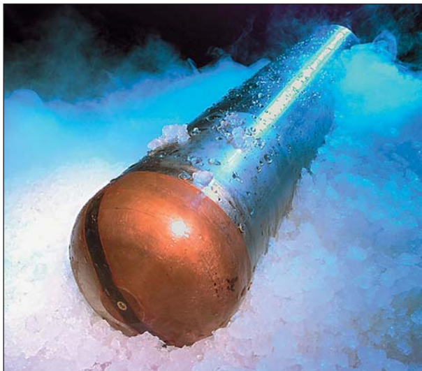
Нижняя часть криобота упала на дно подледникового водоема (по материалам журнала «Science»).
